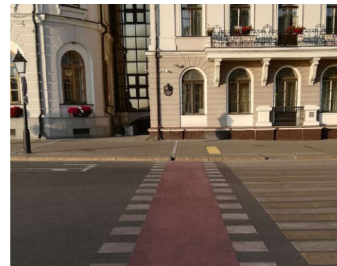
Велопереезды, выделенные разметкой и цветом Краска привлекает внимание участников дорожного движения к участкам пересечения автомобильных и велосипедных потоков
