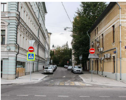
Уширения тротуаров в местах пешеходных переходов за счет прерывания парковочной зоны Используется для успокоения движения транспорта и улучшения видимости пешеходов в зоне перехода
