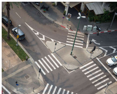
Островки безопасности на перекрестках Используются для удобства пересечения дороги пешеходами, а также для успокоения трафика
